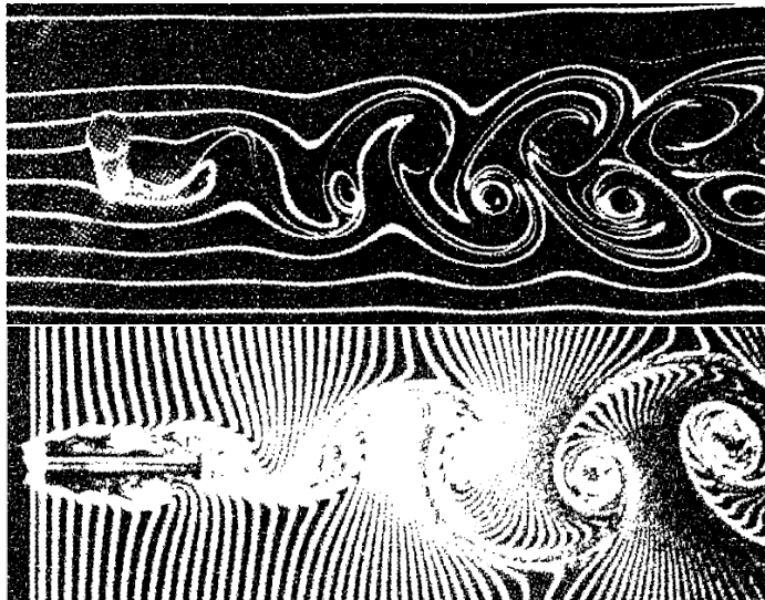
Figuur 35 - Von Karman-wervelstraat bij cirkelvormige en rechthoekige doorsnede [1] (Blevins 2001)
